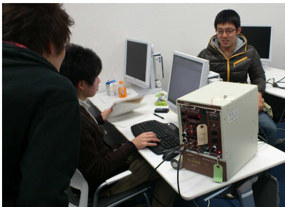
写真 1：放射線計測コースの様子 NaI 検出器と計測回路を組み合わせた 測定実験を行なっているところ。
