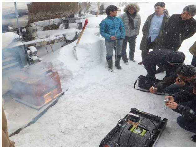
写真 2：高温溶融実験と防災ロボット 説明：北大の実験室内で過酷事故時を想定した防災訓練に用いる遠隔操作のクローラー式の過酷事故対応防災ロボット教材と H2 高温溶融実験の様子（H25 度北大研修）
