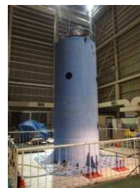
図4 耐震実習 (試験タンク設置状況)
